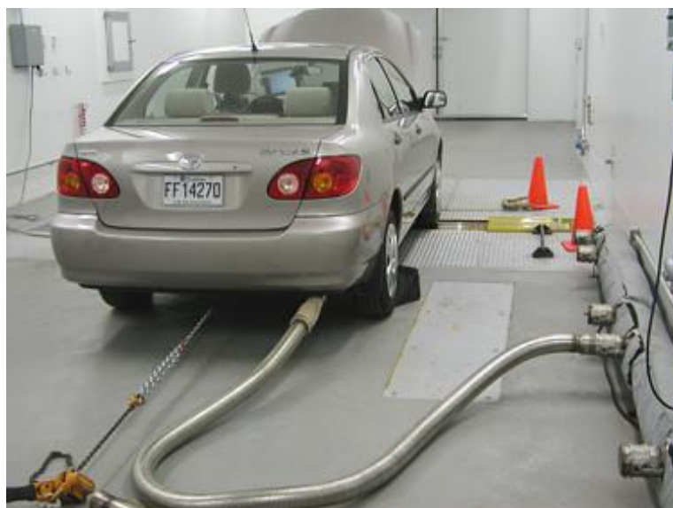
Σχήμα 3.1 - Επιβατικό αυτοκίνητο στο δυναμόμετρο πλαισίων
