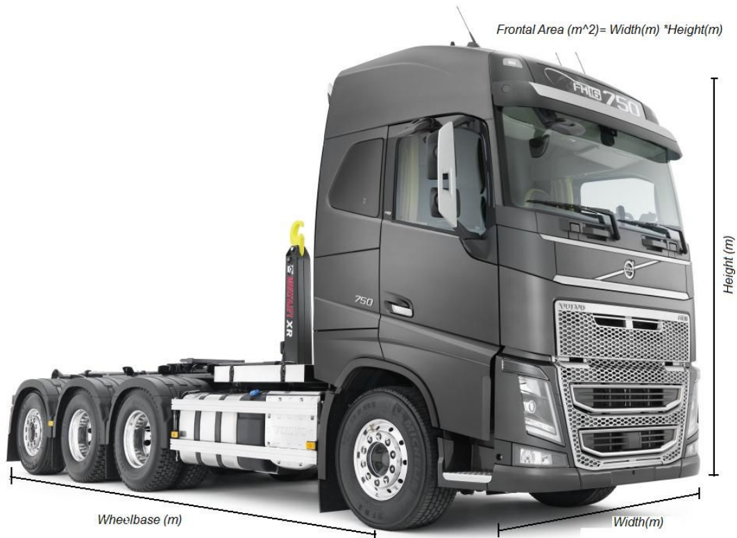
Σχήμα 4.1 - Απεικόνιση βασικών διαστάσεων ενός οχήματος βαρέος τύπου
