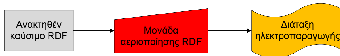
Σχήμα 3.2: Απλή μονάδα αεριοποίησης RDF για ηλεκτροπαραγωγή
