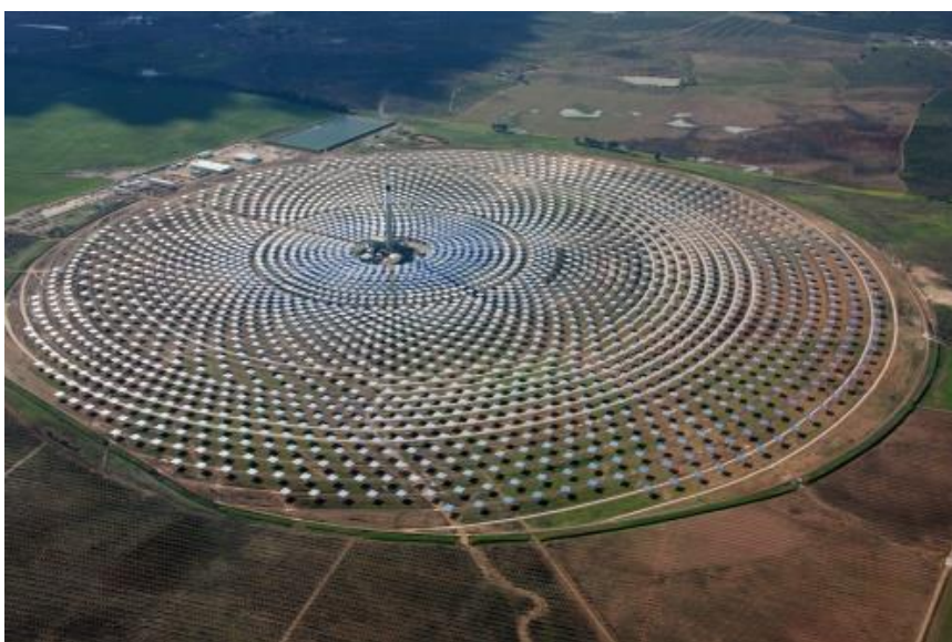
Σχήμα 3.2 Περιβάλλουσα Διάταξη Ηλιοστατικού Πεδίου του Πύργου Gemasolar. [46]
