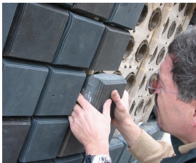
Σχήμα 2.10 Συναρμολόγηση πειραματικού ογκομετρικού δέκτη SolAir3000 [53]
