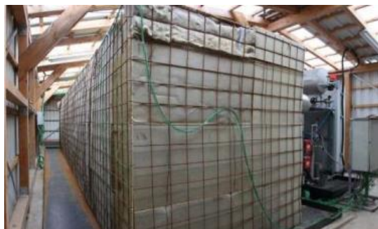
Σχήμα 2.18 Πειραματική διάταξη από σκυρόδεμα με δυνατότητα αποθήκευσης 400 kWh θερμικής ενέργειας [55]
