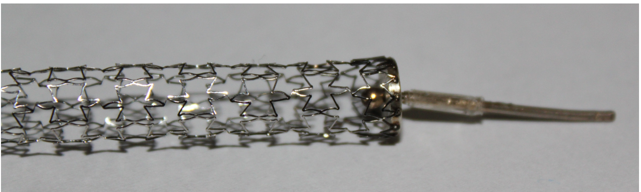
Εικόνα 3.6: Απεικόνιση 316L στεντ με προσθήκη στο άκρο ασημένιου δίσκου και σύρματος με σφαιρικό άκρο .
