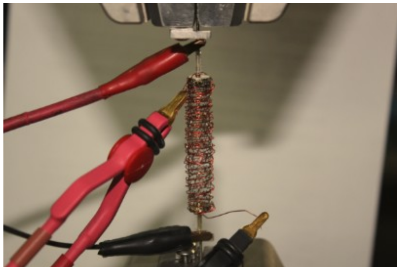
Εικόνα 40. PROTÉGÉ Visi-Pro στις αρπάγες του MTS Insight
