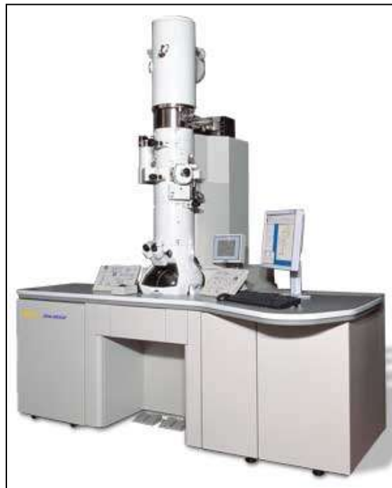
Εικόνα 3.9: Ηλεκτρονικό Μικροσκόπιο Διέλευσης (TEM JEOL 2100 HR) (Τσακίριδης et al. , 2011)
