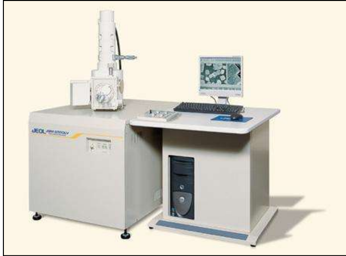
Εικόνα 3.8: Ηλεκτρονικό Μικροσκόπιο Σάρωσης (SEM JEOL JSM 6380 LV) (Χατζηθεοδοφρίδης et al. , 2011)
