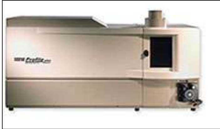
Εικόνα 3.7: Όργανο μεθόδου ανάλυσης ICP-OES (Leeman-Labs, 2012)
