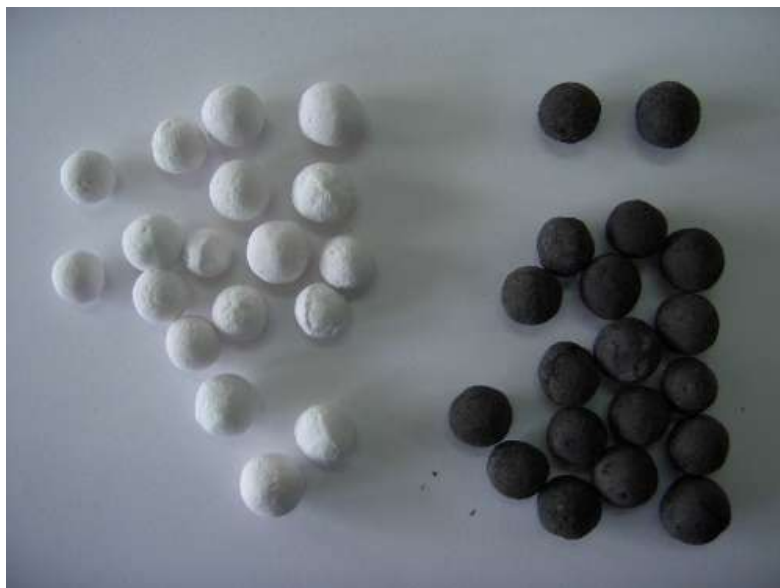
Εικόνα 1.6: Πληρωτικό υλικό της σταθερής κλίνης του θειοαναγωγικού αντιδραστήρα, πριν και μετά την ανάπτυξη της μικροβιακής βιοστοιβάδας. Το μαύρο χρώμα οφείλεται στα ιζήματα των θειούχων ενώσεων των μετάλλων (Ρεμουντάκη, 2012)
