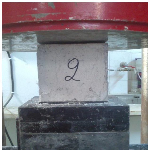
Εικόνα 4.1 Αστοχία δοκιμίου 2 σε μονοαξονική θλίψη.
