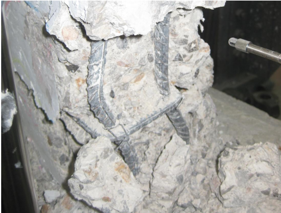
Εικόνα 5.13 Λυγισμός ακραίων ράβδων τοιχίου T9
