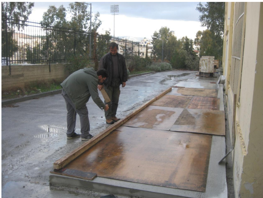
Εικόνα 3.1 Δάπεδο έδρασης δοκιμών
