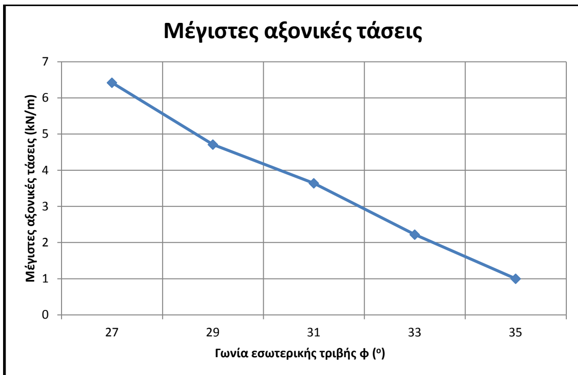
Σχήμα 5-56: Γραφική παράσταση αξονικών τάσεων 2 ου συρματοπλέγματος από τη βάση του επιχώματος σε συνάρτηση με την αύξηση γωνίας εσωτερικής τριβής ( \phi )
