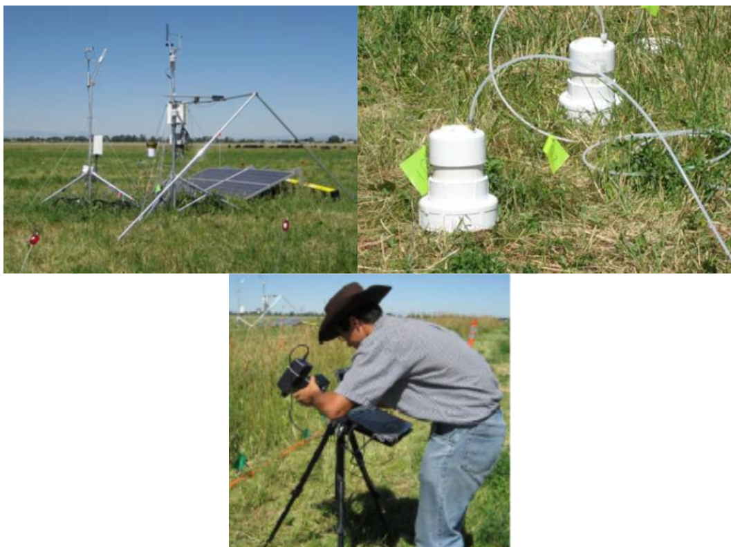
Εικόνα 5.2: Μέθοδοι παρακολούθησης στην επιφάνεια: (α) πύργος παρακολούθησης ροών (Eddy covariance), (β) μετρήσεις αερίων εδάφους (soil gas), γ) Υπερφασματική απεικόνιση της βλάστησης [54].
