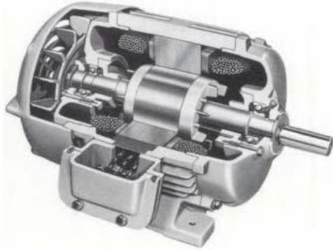
Εικόνα 2.3.1: Εσωτερικό γεννήτριας βραχ. κλωβού
