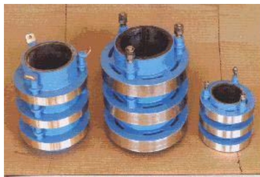
Εικόνα 2.4.2: δρομείς με εμφανείς τους δακτύλιους ολίσθησης
