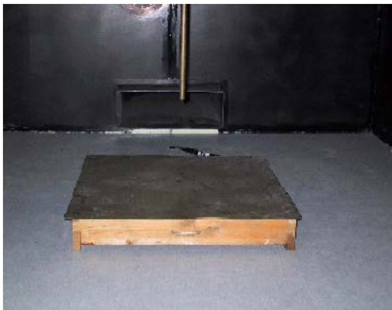
Εικόνα 5.5: Διάταξη ηλεκτροδίων ακίδας-πλάκας στο θάλαμο εκκενώσεων
