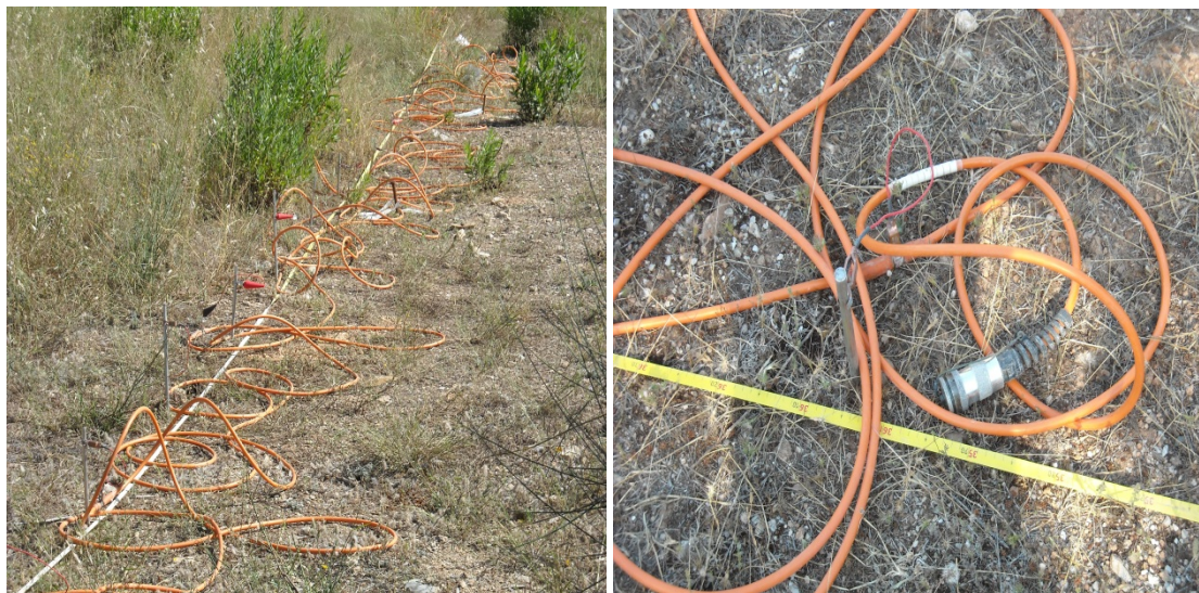
Εικόνα 5.14: Ηλεκτρόδια και σύνδεση πολυκάναλου καλωδίου για τη μέθοδο της τομογραφίας.
