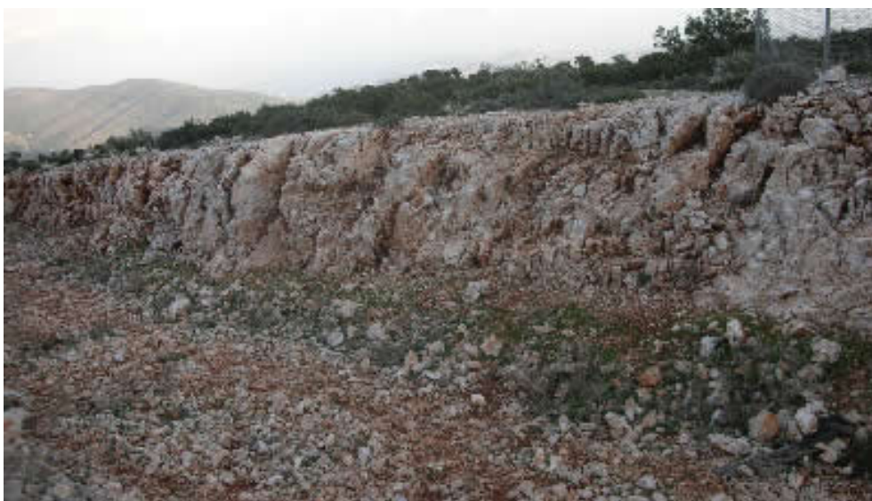
Εικόνα 4.1: Βραχώδες έδαφος με ειδική αντίσταση >2000Ωm.
