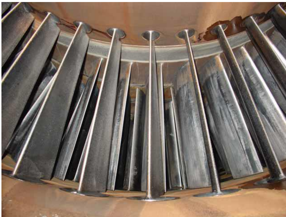
Σχήμα 3.6: Πρώτες βαθμίδες του συμπιεστή του GT32, μετά το Off-Line πλύσιμο στις 15/7/2005.
