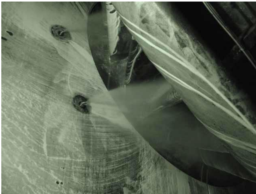
Σχήμα 3.5: Στιγμιότυπο ψεκασμού κατά τη διάρκεια Off-Line πλυσίματος συμπιεστή του GT32 στις 15/7/2005
