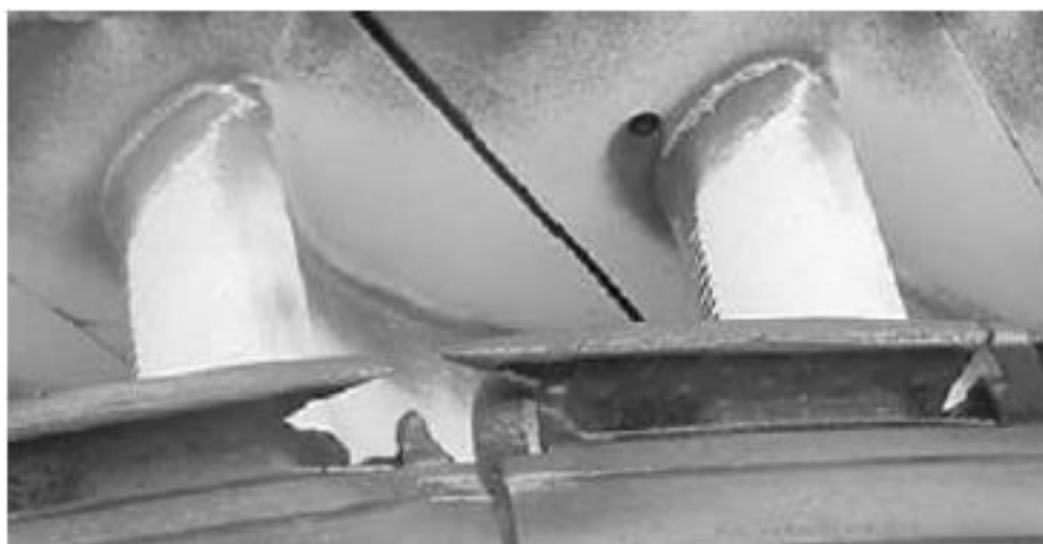
Σχήμα 2.9: Βλάβη στο κέλυφος (εσωτερικά) λόγω Θερμοκρασιακής Διαφοράς. (Boyce, 2006).
