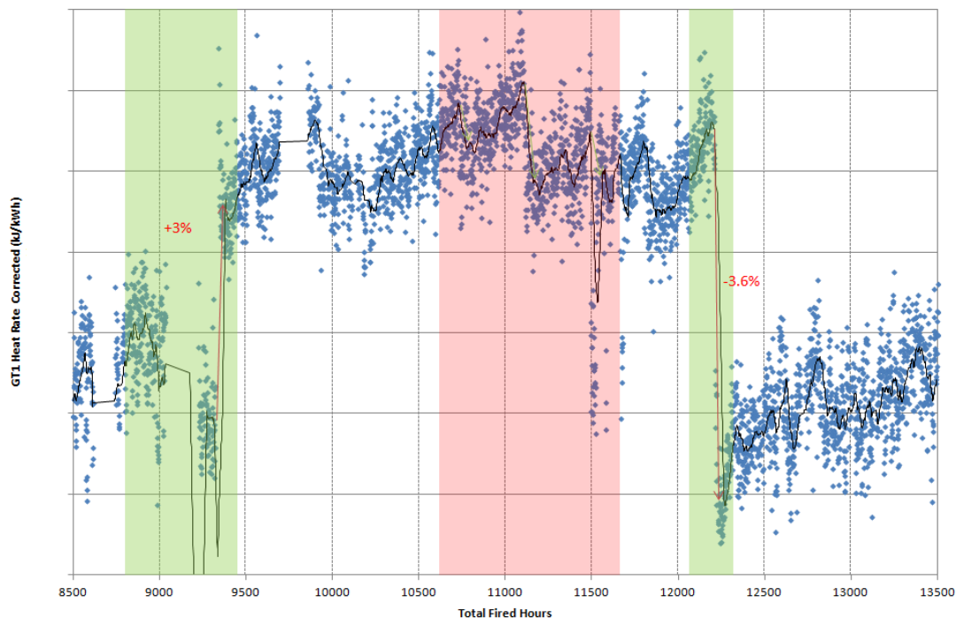
Σχήμα 4.13: Εστίαση και επισήμανση περιοχών με έντονη μεταβολή Ροής Θερμότητας (πράσινο) και περιοχών με μικρότερες μεταβολές (κόκκινο) σε συνάρτηση με τις συνολικές ώρες λειτουργίας, για τον αεριοστρόβilo GT1.
