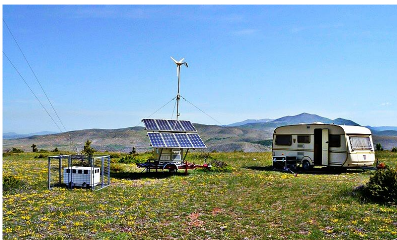
Εικόνα 2.9: LiDAR με αυτόνομο σύστημα παροχής ενέργειας και προσωπικό φύλαξης.
