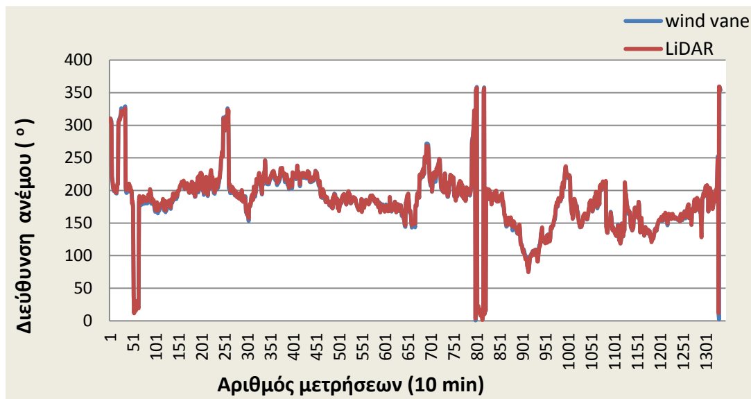
Διάγραμμα 23: Σύγκριση διεύθυνσης ανεμοδείκτη και LiDAR με το χρόνο στα 44 m (ταχύτητα > 4 m/s).
