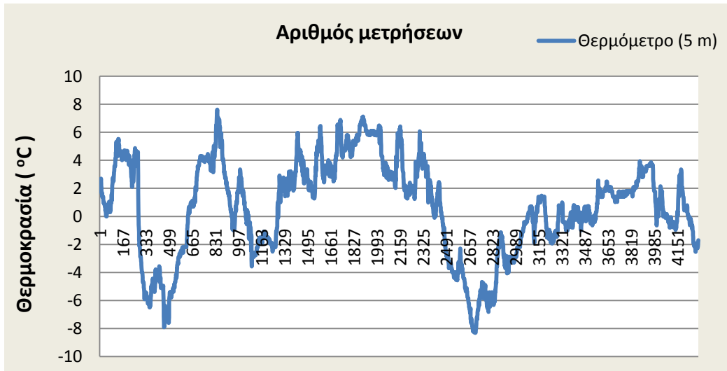
Διάγραμμα 1: Διακύμανση θερμοκρασίας με το χρόνο (θερμόμετρο 5 m)
