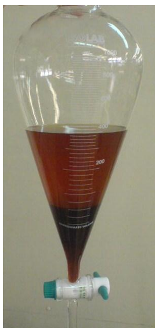
Εικόνα 12 (αριστερά). Μεθυλεστέρες λιπαρών οξέων (FAME) από μαγειρεμένο έλαιο. Χαρακτηριστικό είναι το έντονο καφέ χρώμα. Η πάνω στοιβάδα περιέχει τους μεθυλεστέρες, ενώ η κάτω στοιβάδα περιλαμβάνει την γλυκερίνη, η οποία απομακρύνεται στη συνέχεια.
