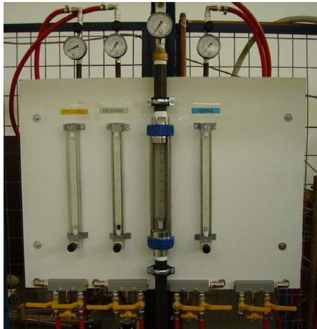
Σχήμα 2.8. Πίνακας ροομέτρων με τα μανόμετρα και τις σφαιρικές βαλβίδες.
