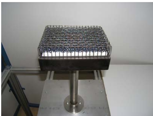
Σχήμα 3.13. α) Η θερμοκάμερα ThermaCAM PM595, β) Η θερμοκάμερα και ο τρόπος σύνδεσης με μόνιτορ, γ) Ο πορώδης καυστήρας, στον οποίο πραγματοποιήθηκαν οι μετρήσεις θερμοκρασίας.
