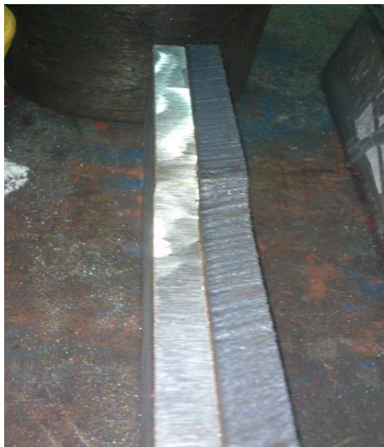
Εικόνα 4.3: Φωτογραφία της επιφάνειας κοπής πριν και μετά το τρόχισμα.
