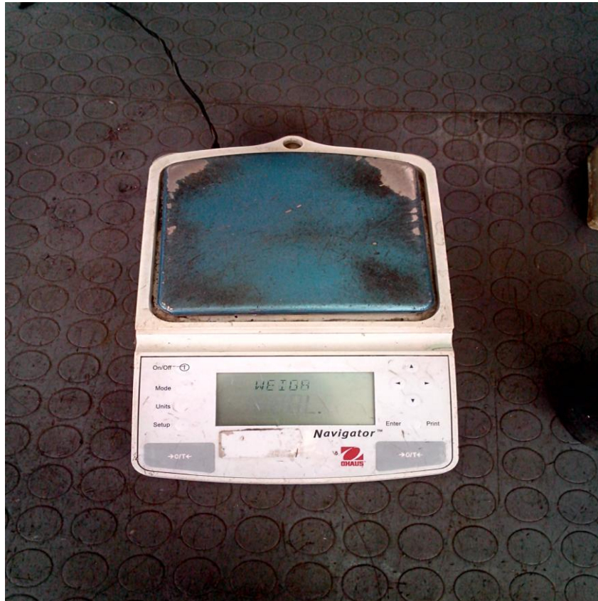
Εικόνα 4.4 : Ηλεκτρονική ζυγαριά της εταιρείας Navigator που χρησιμοποιήθηκε για όλες τις μετρήσεις βαρών
