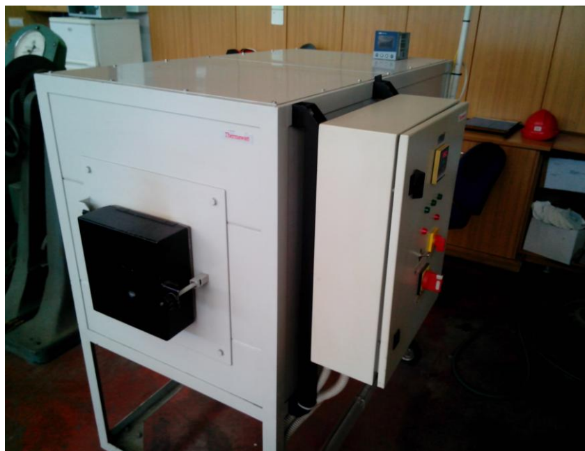
Εικόνα 4.2 : Φούρνος Thermawatt, χρησιμοποιήθηκε για όλες τις θερμικές κατεργασίες
