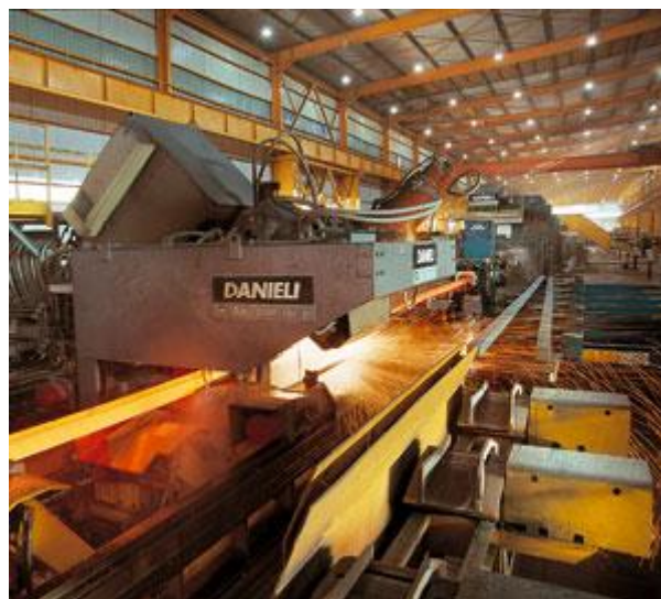
Εικόνα 3.18 : Θερμή έλαση μπιγιέτας για παραγωγή χάλυβα[8]
