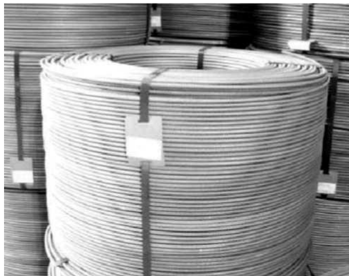
Εικόνα 3.21: Σύρμα χάλυβα σπλισμού που έχει παραχθεί με τη μέθοδο ψυχρής έλασης
