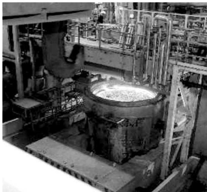
Εικόνα 3.14 : Κάδος δευτερογενούς χαλυβοποίησης
