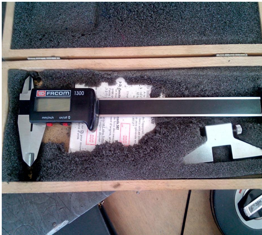
Εικόνα 4.6 : Ηλεκτρονικό παχύμετρο της εταιρείας Facom, ακριβείας δύο δεκαδικών ψηφίων, το οποίο βοήθησε στις μετρήσεις της χάραξης
