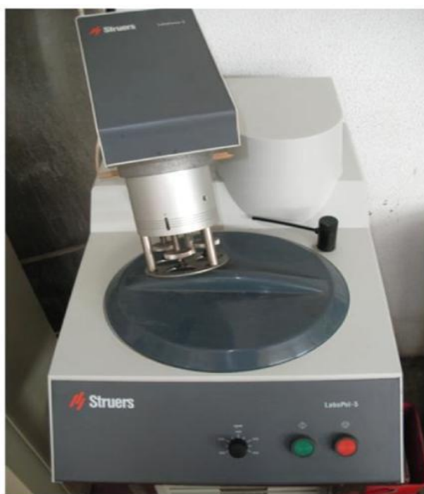
Εικόνα 4.9 : Μηχανή λείανσης και στίλβωσης της εταιρείας Struers
