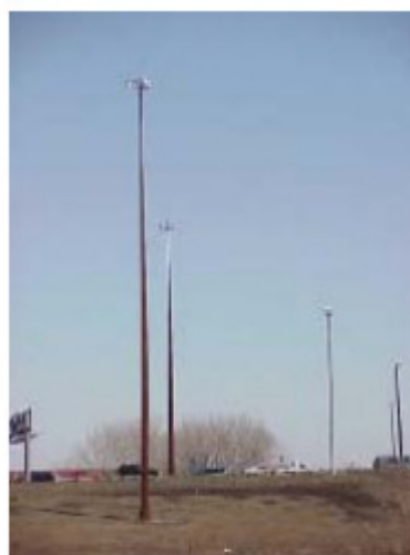
Εικ. 3.3 – Ιστοί φωτισμού με διπλό ή δίδυμο βραχίονα (αριστερά) και φωτισμός επί υψηλών ιστών (δεξιά)
