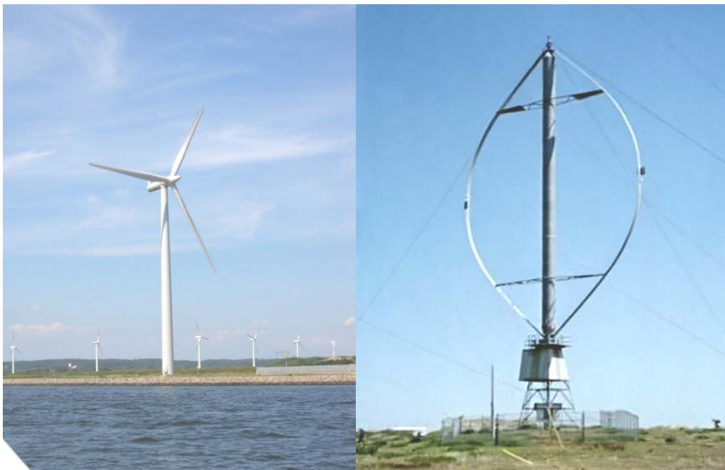
Εικόνα 2: Γρήγορη αιολική μηχανή και αιολική μηχανή κατακόρυφου άξονα τύπου Darrieus Picture 2: Fast windmill and vertical axis wind machine Darrieus type
