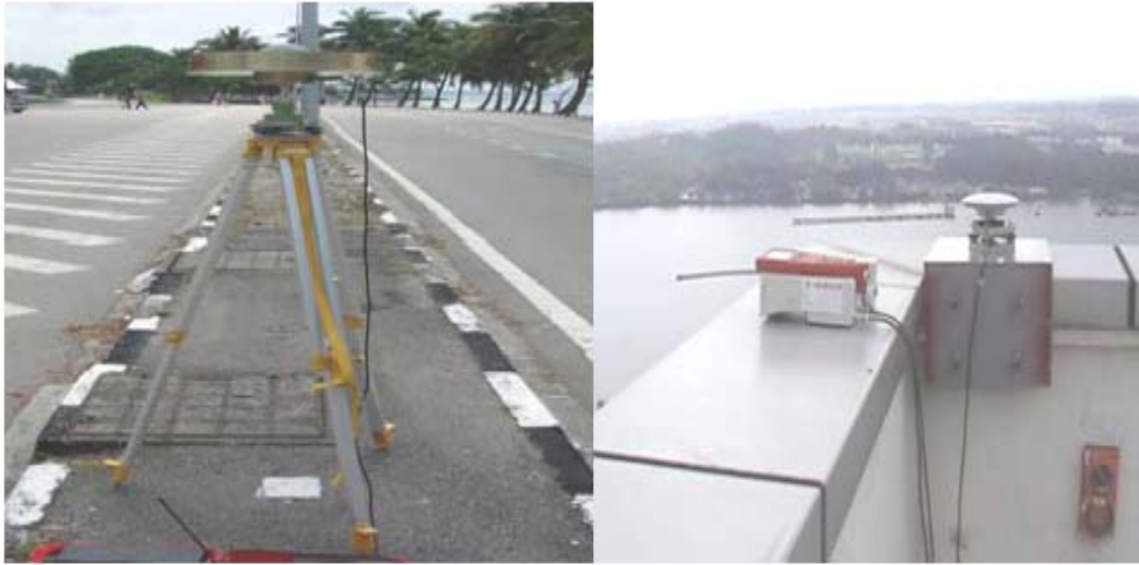
Εικόνα 16: Το ζεύγος δεκτών GPS της Leica με τον σταθμό αναφοράς σε σταθερό σημείο και τον κινητό δέκτη πάνω στην οροφή του κτιρίου
