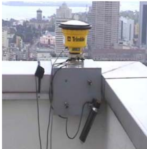
Εικόνα 17: Ο κινητός δέκτης (rover) της Trimble τοποθετημένος πάνω στην οροφή του κτιρίου
