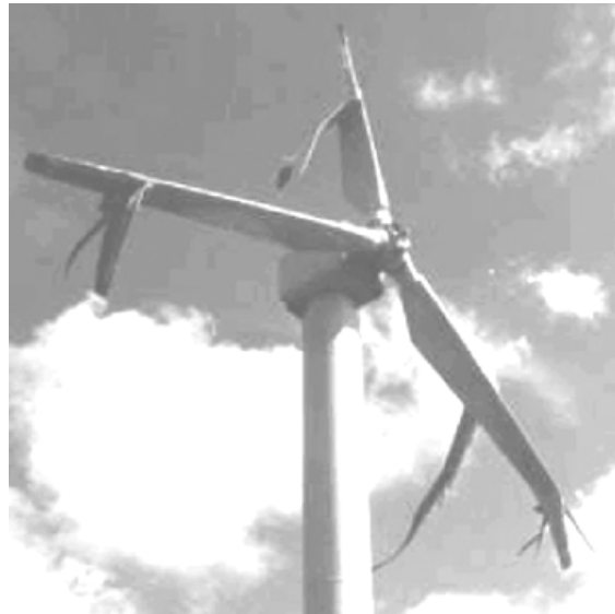
Εικόνα 7: Αποκόλληση των στρωμάτων των πτερυγίων Picture 7: Detachment of the blade layers
