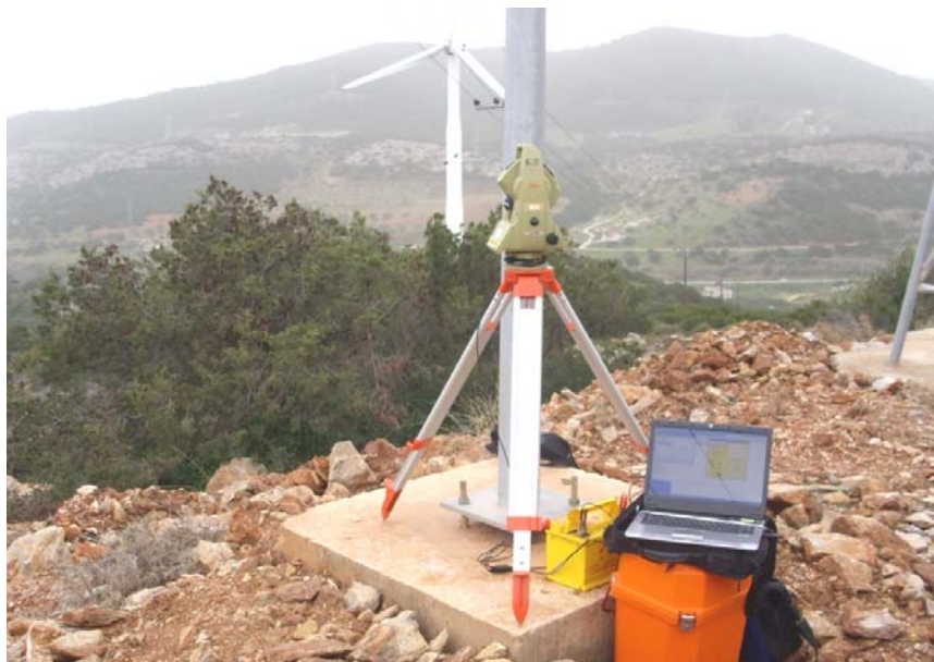
Εικόνα 38: Ο Γεωδαιτικός Σταθμός Leica TCA1800 σε σύνδεση με φορητό Η/Υ κατά τη διάρκεια μετρήσεων
