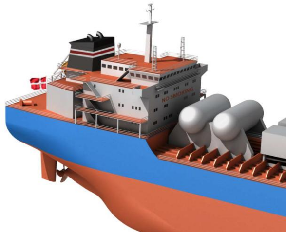
Εικόνα 29. Δεξαμενές LNG σε bulk carrier
