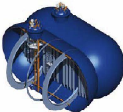
Εικόνα 28. Δεξαμενή αποθήκευσης LNG bilobe tank.
