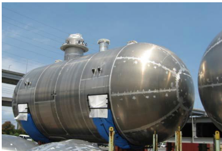
Εικόνα 26. Δεξαμενή αποθήκευσης LNG
