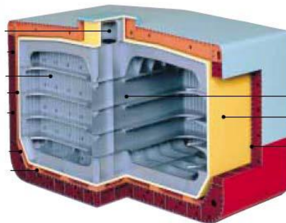
Εικόνα 24. Δεξαμενή αποθήκευσης LNG
