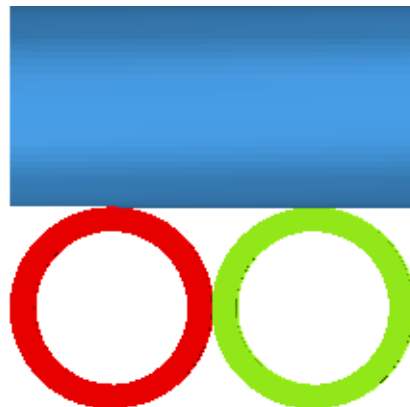
Σχήμα 3.2. Παρουσίαση δοκιμών 19x25 (mm x mm) όπως προσομοιώνονται στο πρόγραμμα πεπερασμένων στοιχείων LS-DYNA.
