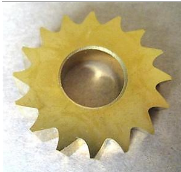
Εικόνα 3.9: Κοπτικό εργαλείο καρβιδίου με επικάλυψη νιτρικού τιτανίου [22]
