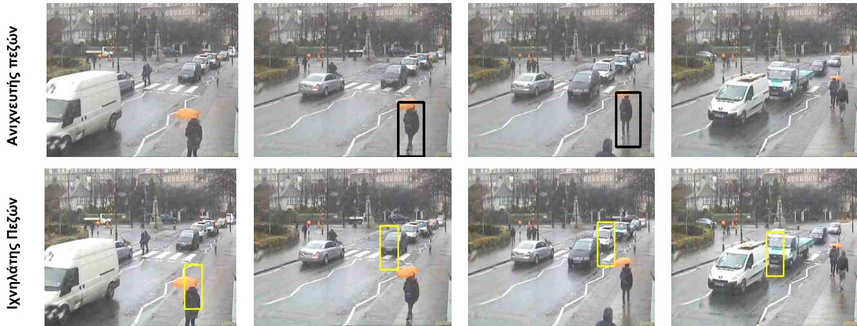
Σχήμα 17. Σε αυτό το πείραμα παρουσιάζονται τα οφέλη της ροής αντικειμένου. Οι προσεγγίσεις οπτικής ροής αποπροσανατολίζονται, όταν παρόμοια αντικείμενα κινούνται προς την ίδια ή διαφορετική κατεύθυνση με το αντικείμενο-του-ενδιαφέροντος (τρίτη γραμμή). Επιπλέον, οι προσεγγίσεις ανθρώπινης ανίχνευσης δεν έχουν σταθερό ρυθμό ανίχνευσης (τέταρτη γραμμή). Επίσης, ο εντοπισμός αντικειμένων δυσκολεύει σε σύνθετα περιβάλλοντα (πέμπτη γραμμή). Αντιθέτως η ροή αντικειμένου (δεύτερη σειρά) μπορεί να προσομοιώσει το πεδίο κίνησης ενός αντικειμένου με επιτυχία, ενώ παράλληλα είναι σε θέση να επικεντρώνετε μόνο στο αντικείμενο υπό μελέτη.
