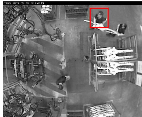
Σχήμα 27. Ενδεικτικά αποτελέσματα. Τα συστήματα OAB1 και MIL (δεύτερη και τέταρτη γραμμή) παρασύρονται μακριά από το στόχο, δεδομένου ότι επηρεάζονται από το βιομηχανικό περιβάλλον. Το OAB5 (τρίτη γραμμή) δεν παραμένει απολύτως εστιασμένο στο στόχο για όλη την ακολουθία εικόνων. Ο Color tracker (πέμπτη γραμμή) έχει εντελώς ασταθή απόδοση, δεδομένου ότι επηρεάζεται από άλλα χρώματα (π.χ. σπινθήρες από την μηχανή συγκόλλησης). Η προτεινόμενη προσέγγισή (έκτη γραμμή) παραμένει επικεντρωμένη στον κινούμενο στόχο για όλη την ακολουθία.
