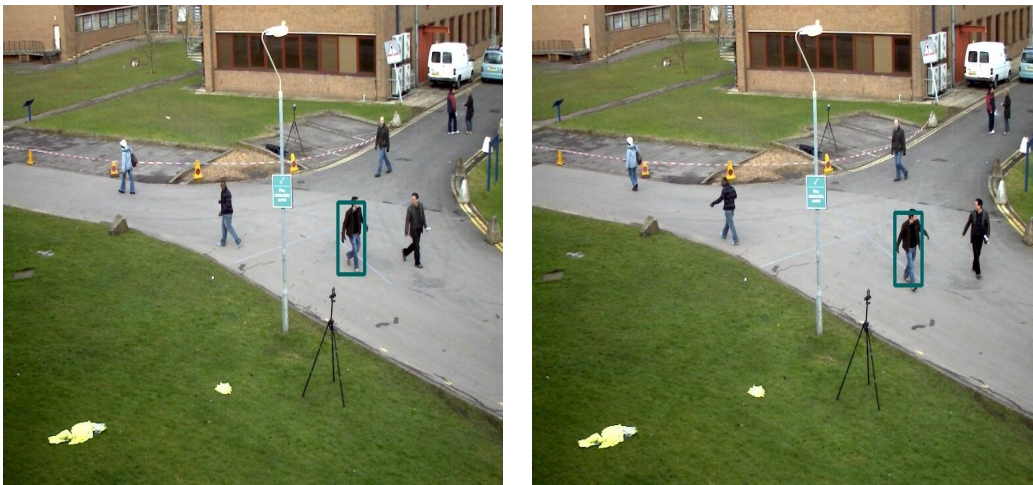
Σχήμα 10. Εκτίμηση κίνησης ενός συγκεκριμένου ανθρώπου σε δύο εικόνες βίντεο, όπου παραβιάζεται η χρονική συνέχεια ( violation of temporal continuity ). Η εκτίμηση γίνεται με την μέθοδο gradient based multi-resolution estimation .
