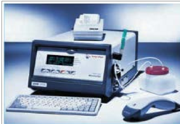
Εικόνα 3.2 Ιξωδόμετρο SVM 3000 Stabinger
