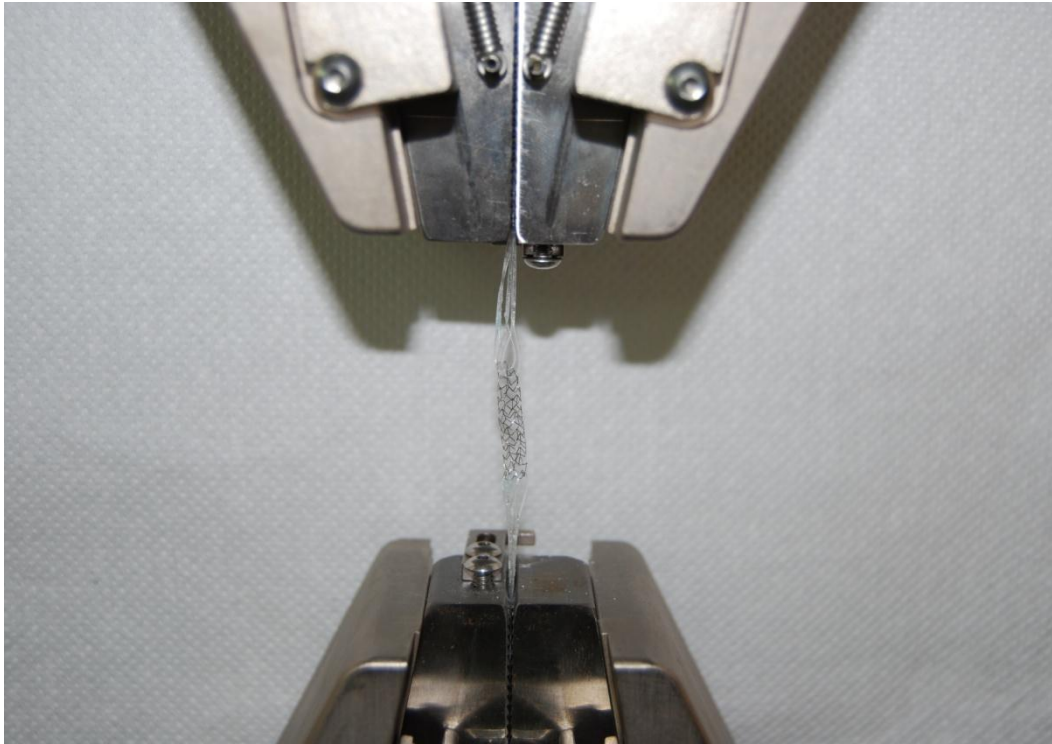
Εικόνα 4.7 Το 316L stent τοποθετημένο μεταξύ των αρπαγών του πλαισίου.
