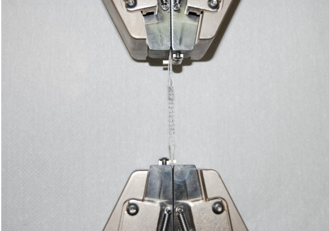
Εικόνα 4.8 Επιμήκυνση κατά την δοκιμή εφελκυσμού στο 316L stent.
